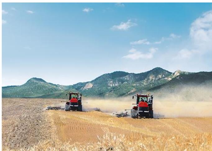
*Légende : L'automatisation supervisée, l'une des cinq catégories d'automatisation définies par Case IH, permet au conducteur d'un tracteur de superviser la conduite d'un autre tracteur sans conducteur qui évolue dans le même champ.*
